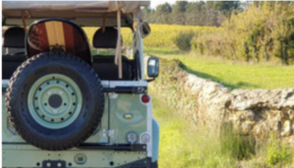
Ce porte roue de secours se fixe sur la traverse arrière et sur un dixième point de renfort sur la caisse pour éviter les vibrations de la porte arrière sur les chemins et éviter à la porte arrière de supporter le poids de la roue de secours qui fatigue la porte arrière ainsi que ces chernières.
