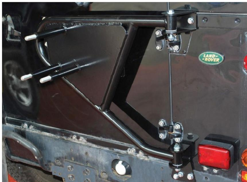
Ce porte roue de secours se fixe sur la traverse arrière et sur un dixième point de renfort sur la caisse pour éviter les vibrations de la porte arrière sur les chemins et éviter à la porte arrière de supporter le poids de la roue de secours qui fatigue la porte arrière ainsi que ces charnières.
